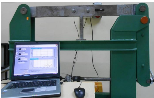
Rys.2. Stanowisko laboratoryjne do badań połączeń gwintowych: 1-rama, 2-płyta zewnętrzna, 3-płyta wewnętrzna, 4-napinana śruba, 5-Czujnik siły (zakres 5kN), 6-ciężno, 7-dźwignia przenosząca obciążenie, 8-pokrętło, 9-środek obrotu dźwigni, 10-podkładki centrujące, 11- czujniki siły osiowej śruby (zakres 80kN), Q – napięcie w śrubicie ( Q_F - wartość otrzymana z pomiarów, Q_w - wartość teoretyczna)
