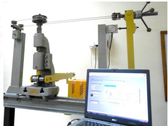
Rys. 1. Stanowisko do badania sprawności mechanizmu śrubowego: 1- korpus praski śrubowej, 2 - nakrętka, 3 - śruba, 4 - kółko liniowe, 5 - szczęka ruchoma, 6 - podpora dźwigni, 7 - dźwignia dwuramienna, 8 - zespół obciążników, 9 - korpus stanowiska, 10 - dźwignia, 11 - śruba napinająca, 12 - pokrętło, 13 - układ krążników liniowych z linką, 14 - czujnik siły, 15 - kulka
